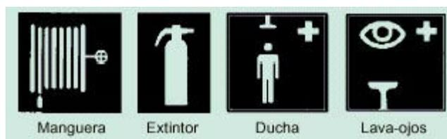
**Fig. 6: Señalización de los elementos de actuación**
